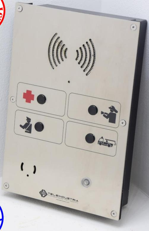
**STEELVOX-ip™** è un telefono **SMART VoIP (SIP)** Full-Duplex realizzato con una robusta piastra in acciaio inossidabile (spessore 2 mm) resistente al vandalismo e agli urti **IK10**, con protezione **IP66**. È dotato di una cornice metallica per il montaggio a incasso. La famiglia **STEELVOX-ip™** è adatta per essere installata su qualsiasi colonnina SOS della nostra gamma. Assicura un'alta qualità di conversazione in ambienti stradali anche con un elevato rumore di fondo.
