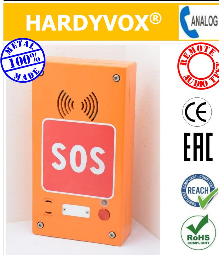
**HARDYVOX®** è un telefono **analogico SMART** a mani libere **Full-Duplex** interamente realizzato in **pressofusione di alluminio** (spessore 5mm) antivandalo e resistente agli urti **IK10**, con grado di protezione **IP66**.
