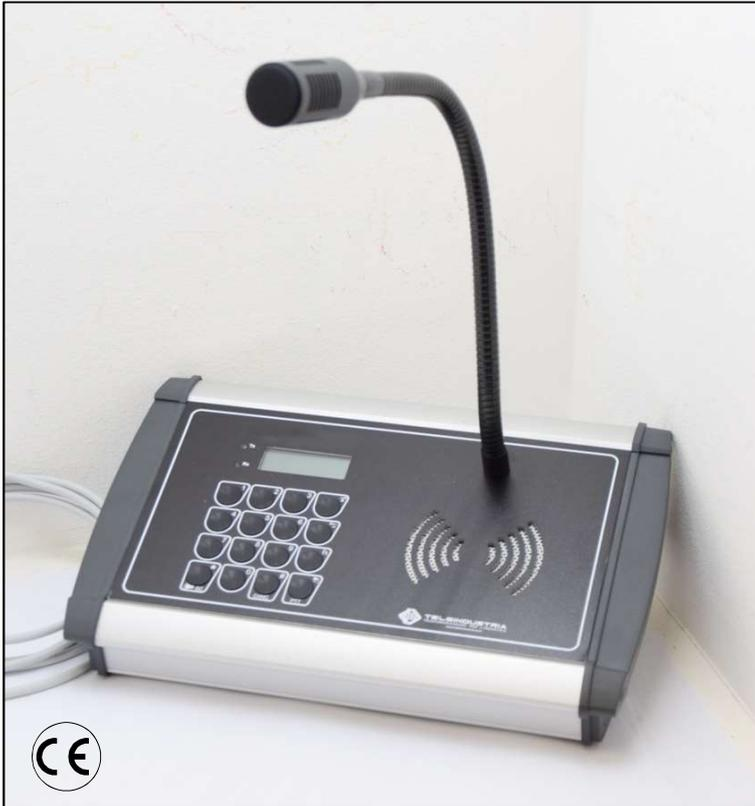
Le système d'interphone OCEAN® est basé sur une «intelligence distribuée». Chaque poste d'interphone est une unité autonome, totalement indépendante des autres. Le système n'a pas besoin d'une unité de commutation centralisée, mais d'un simple câble téléphonique (2x0,6mm) où toutes les stations sont connectées en parallèle.
