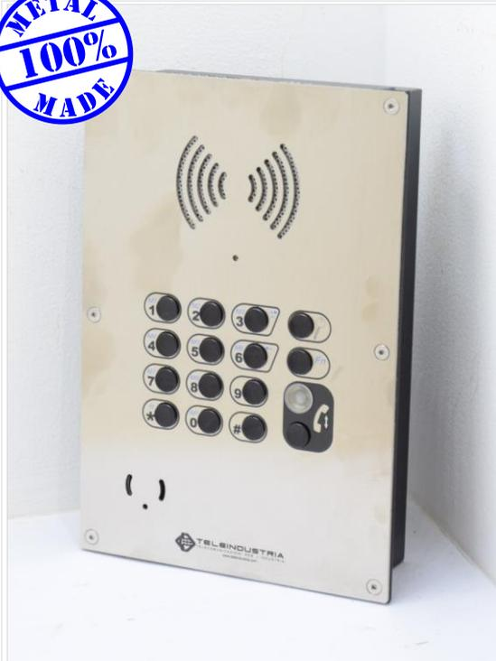
**STEELVOX®** è un telefono **analogico SMART** a **mani libere Full-Duplex** realizzato con una robusta piastra di **acciaio INOX** (spessore 2mm) antivandalo e resistente agli urti **IK10**, con grado di protezione **IP66**. Viene fornito con un telaio metallico per **incasso a parete o retro-pannello**.
